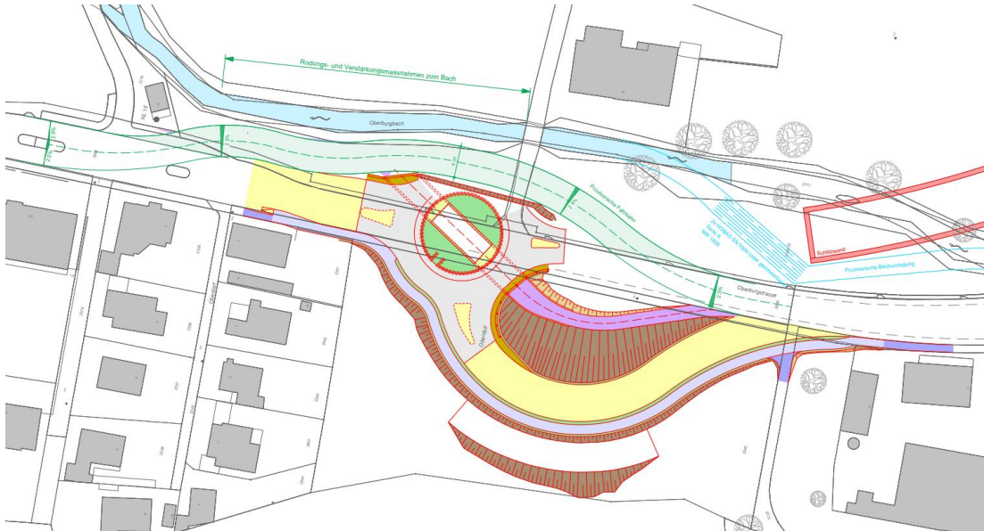
Abbildung 56: Umfahrung Kreisel während Bauphase 1
